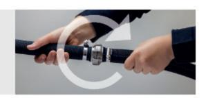
Die beiden Kupplungen werden stirnseitig versetzt zusammengeführt, sodass die Dichtflächen in Kontakt kommen. Anschließend ist eine Kupplungshälfte gegenüber der anderen Hälfte bis zum Anschlag zu verdrehen - die Kupplung rastet ein.
